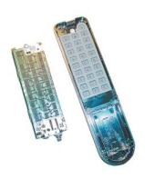
Чтобы полностью восстановить нормальную работу «засалившегося» пульта дистанционного управления телевизором, иногда достаточно вскрыть его корпус, промыть содержимое водой с мылом и как следует высушить.
