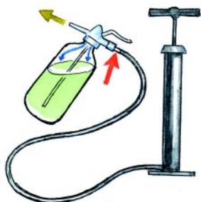
Чтобы превратить старый сифон в шприц-масленку, достаточно заменить иглу, которая прокалывает баллончик с газом, ниппелем от автомобильной камеры. Заполнив емкость маслом и создав давление с помощью обычного насоса, вы без дополнительных усилий зальете смазку в механизм (например, в коробку передач автомобиля) под любым углом к горизонту.
