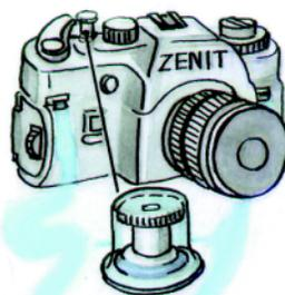
В фотоаппарате «Зенит» часто «садится» батарейка из-за того, что в сумке кнопка затвора может быть случайно нажата каким-нибудь предметом. Наденьте на кнопку крышечку от тубы с валидолом, и надежная защита готова.
