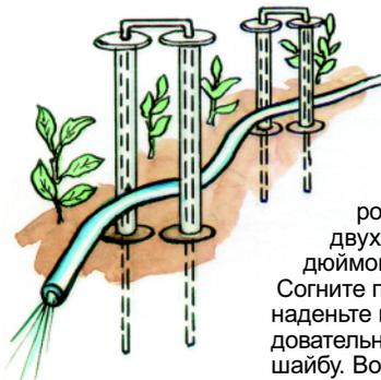
Чтобы поливочный шланг не сминал нежные посадки, пропустите его через небольшие «ворота». Сделать их несложно из стального прутка диаметром 6—8 мм, четырех больших шайб, вырезанных из старой пластиковой канистры, и двух отрезков обычной полудюймовой водопроводной трубы. Согните пруток в форме буквы «П», наденьте на каждую «ножку» последовательно шайбу, трубку и еще одну шайбу. Воткните конструкцию в землю и пропустите под ней шланг.
