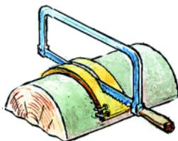
Прежде чем делать пропил в тонкой и упругой металлической полоске, ее следует слегка согнуть и зафиксировать концы в упорах.
