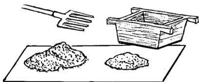
Замечено, что перемешивать компоненты цементного раствора при его подготовке удобнее не лопатой, а садовыми вилами: и работа облегчается, и смесь получается более однородной.
