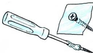
Еще один способ завинтить шуруп в труднодоступное отверстие: проткните шурупом кусочек клейкой ленты, ее концы загните на стембель отвертки и ввинчивайте.
