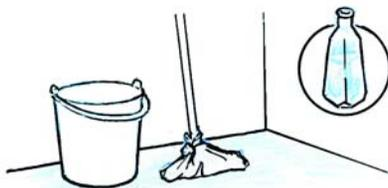
Прежде чем покрасить цементный пол, вымойте его теплой водой, дайте просохнуть в течение суток и протрите обычным уксусом. Краска будет держаться прочнее.
