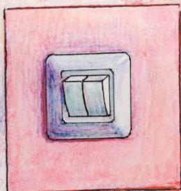
При установке переговорного устройства домофона сразу же вставьте в цепь выключатель, который позволит отключать устройство, избегая разговоров с нежелательными посетителями.
