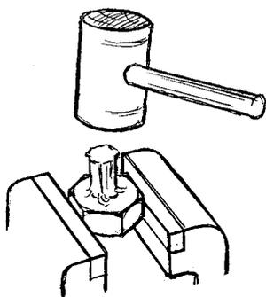
Деревянные штифты для мебели быстрее всего изготовить так: наколите из любого бруска ножом заготовки подходящего размера, а потом прогоните их ударами молотка через зажатую в тисках гайку соответствующего диаметра.
