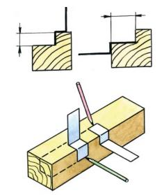
Точно скопировать и нанести размеры паза на деревянную заготовку можно при помощи полоски мягкого металла. изогнув ее по форме паза.
