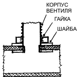
Не спешите отказываться от велосипедной камеры, которая стала пропускать воздух в месте вулканизации вентиля. Установите на его место вентиль старой конструкции, который укреплялся на камере с помощью гайки, и камера еще послужит.
