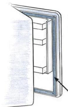
Если уплотнительная резина дверцы холодильника прилипает к шкафу, смажьте поверхность уплотнения тонким слоем подсолнечного масла (ни в коем случае не машинным — оно разъедает резину), и порок исчезнет.
