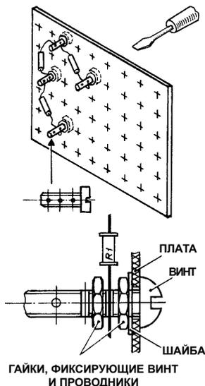
Для сборки «экспериментальных» электронных схем не всегда имеет смысл делать печатные платы. Опытный экземпляр можно собрать на гитиновой пластине при помощи обычных винтов с просверленными в них отверстиями. Сами винты и проводники радиодеталей крепятся при помощи гаек.
