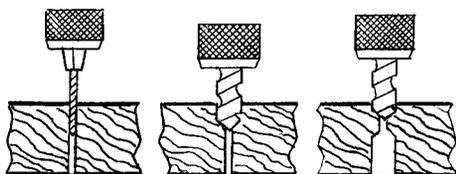
Избежать скола при сверлении деревянной детали можно так: вначале просверлить отверстие меньшего размера, потом сверлить основным сверлом с одной стороны до середины, а затем перевернуть деталь и досверлить с другой стороны.
