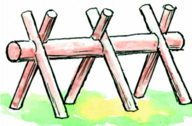
Соорудив на скорую руку такую примитивную таль, вы умножите свои силы, вытаскивая лодку на берег или даже помогая выбираться из грязи застрявшему автомобилю. А если смазать трещущиеся поверхности, дело пойдет еще легче.
