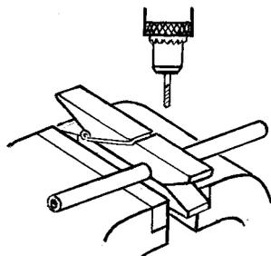
Чтобы точно просверлить металлическую трубку небольшого диаметра, воспользуйтесь деревянной бельевой прищепкой, зажав ее вместе с трубкой в тисках.
