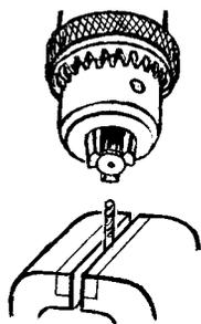
Рассверливать маленькие шайбы и втулки нужно так: втулку закрепить в патроне сверла, а сверло зажать в тисках.
