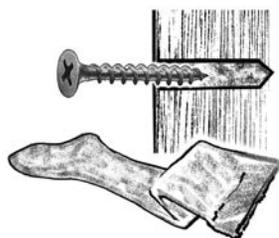
Гнездо расшатавшегося в мебели шурупа можно надолго укрепить следующим способом: плотно набейте отверстие кусочками капрона от старых чулок, затем расплавьте капрон с помощью раскалённого гвоздя и вворачивайте шуруп.
