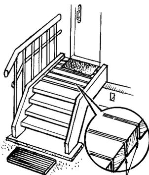
ЗАЗОРЫ 5—10 ММ
