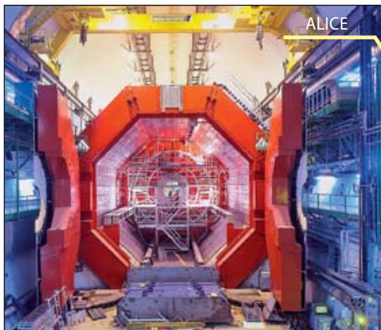
Детектор ALICE позволяет исследовать горячую и плотную кварк-глюонную плазму.
