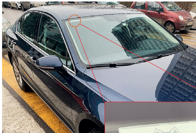
Радиочастотную автометку можно устанавливать в верхней части лобового стекла.
