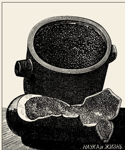
Рис. 1. Тигли, в которых получены искусственные рубины.
