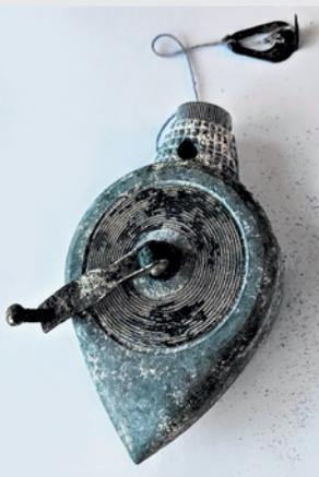
Это так называемый отбивочный, он же разметочный или трассирующий, шнур. Белый порошок, высыпавшийся из корпуса прибора, это мел, который
