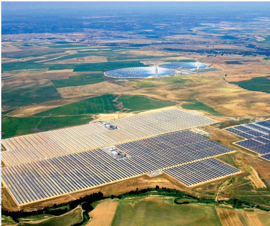
*Аэрофотоснимок системы солнечных электростанций, входящих в комплекс Solucar (Испания). На переднем плане солнечные электростанции параболического типа Solnova I (справа), III (слева спереди) и IV (слева сзади). В глубине расположены первая коммерческая солнечная электростанция башенного типа PS10, а за ней PS20.*
