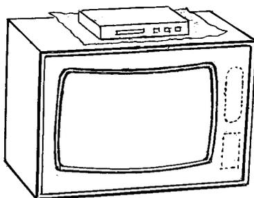
Когда из-за нехватки места проигрыватель DVD ставят на телевизор, изображение часто страдает из-за помех. Проложите между этими электронными устройствами листок металлической фольги для экранирования электромагнитных волн.
