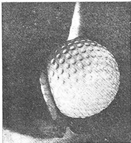
Рис. 14. Резиновый мяч, снятый в момент удара о твердое препятствие.
