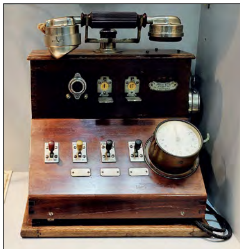
Прообраз таксофона — оборудованный таймером аппарат фирмы «La sequanaise electrique P. Jacquesson», модель 5238; был предназначен для гостиниц. Франция, 1910 год.
