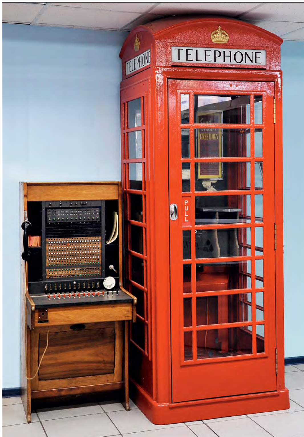
Немецкий ручной коммутатор на 12 линий с возможностью выхода на городские АТС и лондонская телефонная будка первыми встречают посетителей московского отделения музея.
