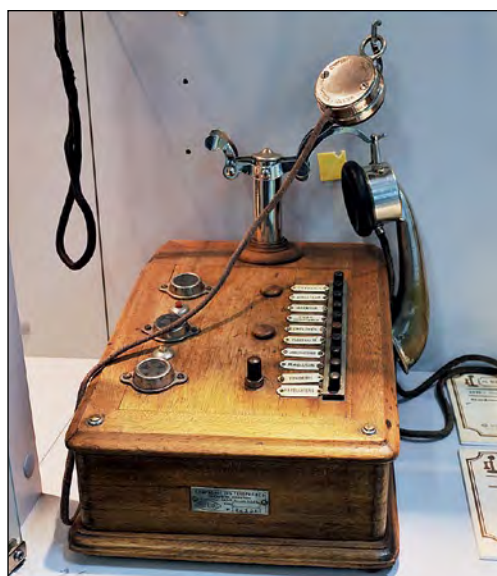
Офисный настольный коммутатор «Thomson-Houston» на 10 номеров. Франция, 1920 год.
