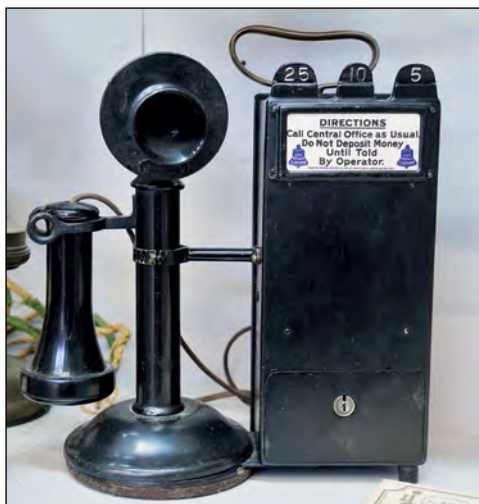
Телефон фирмы «Western Electric» системы ЦБ, оборудованный таксофонной приставкой Gray Telephone Station для приёма монет в 5, 10 и 25 центов. Чтобы им воспользоваться, надо было сначала обычным образом вызвать телефонистку и опускать монеты только после того, как она подключит нужного абонента. США, 1915 год.
